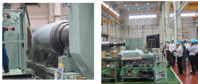
大径ロール軸のテスト研削加工と熱心に見入る見学参加者
